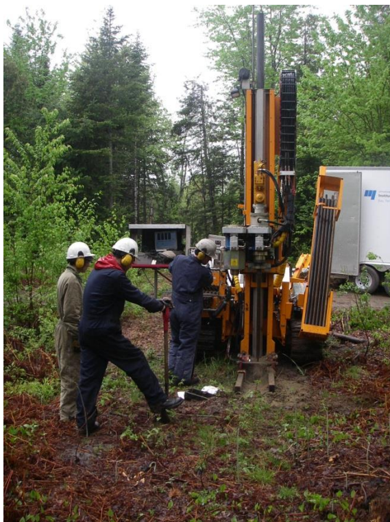
Figure 4 : Foreuse INRS équipée d'un piézocône (modèle Geotech 605D)
