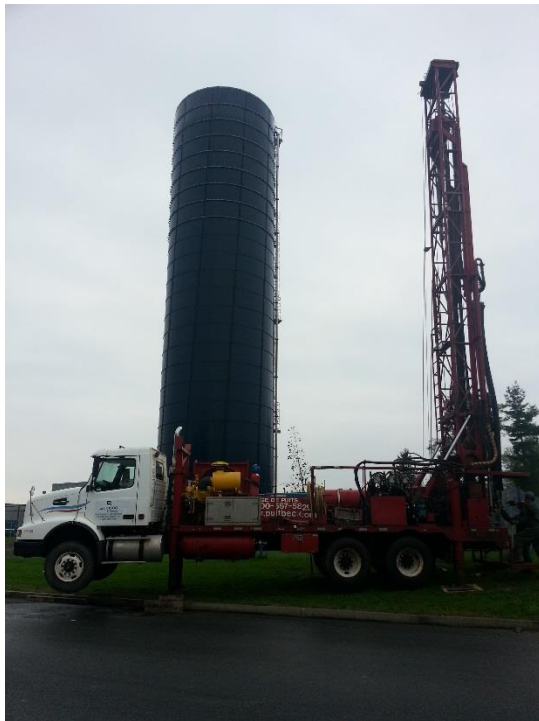
Figure 2 : Foreuse rotative (modèle Speedstar)
