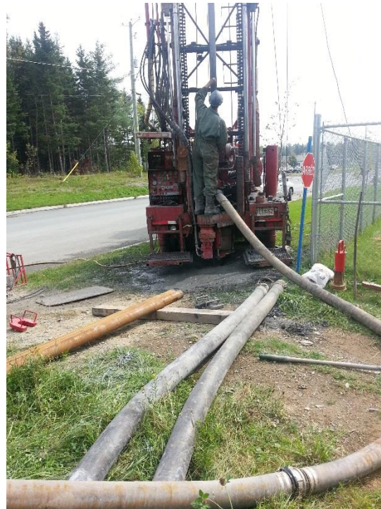
Figure 2 : Foreuse rotative (modèle Speedstar)
