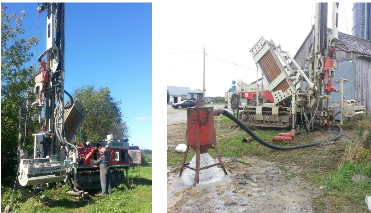
Figure 3 : Foreuse rotative sur chenilles (modèle Comacchio MC-900P)
