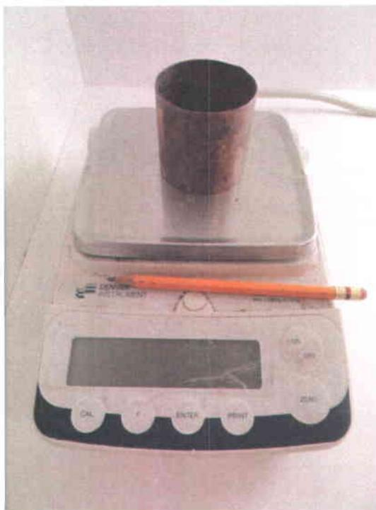
**Figure I.13 : Photo d'un cylindre en cuivre servant à l'échantillonnage de sol, posé sur une balance de précision (MXX-5001, Denver Instrument).**
