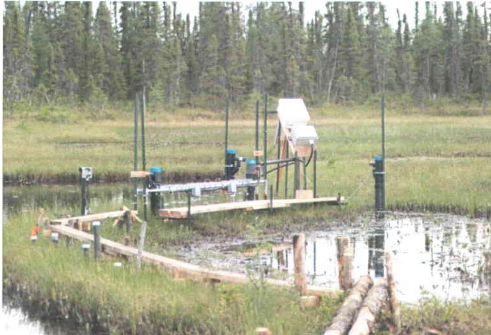
**Figure I.15 : Photo du dispositif permettant la mesure de l'emmagasinement spécifique de différentes couches de tourbe. Les capteurs ont été attachés au portique en acier gris (milieu de la photo). Des trottoirs permettaient de se rendre sur le site sans perturber le milieu.**
