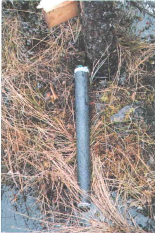
**Figure I.17 : Photo d'un lest utilisé pour les tests de conductivité hydraulique.**
