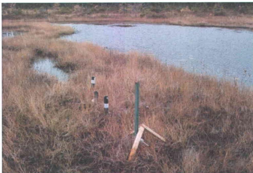
**Figure I.14 : Photo d'un système de mesure « Ancré-Flottant » au niveau d'une lanière. La barre de métal verte constitue l'encrage dans le substratum minéral. Les morceaux de bois constituent le trépied flottant à la surface de la tourbe.**
