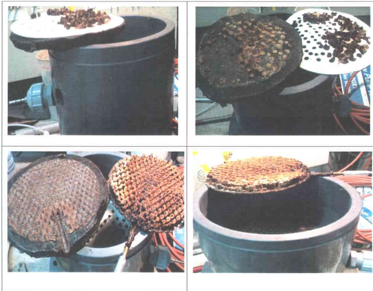
Figure A.2 Photographie montrant l'entartrage des électrodes lors des essais en continue pendant 1 mois
