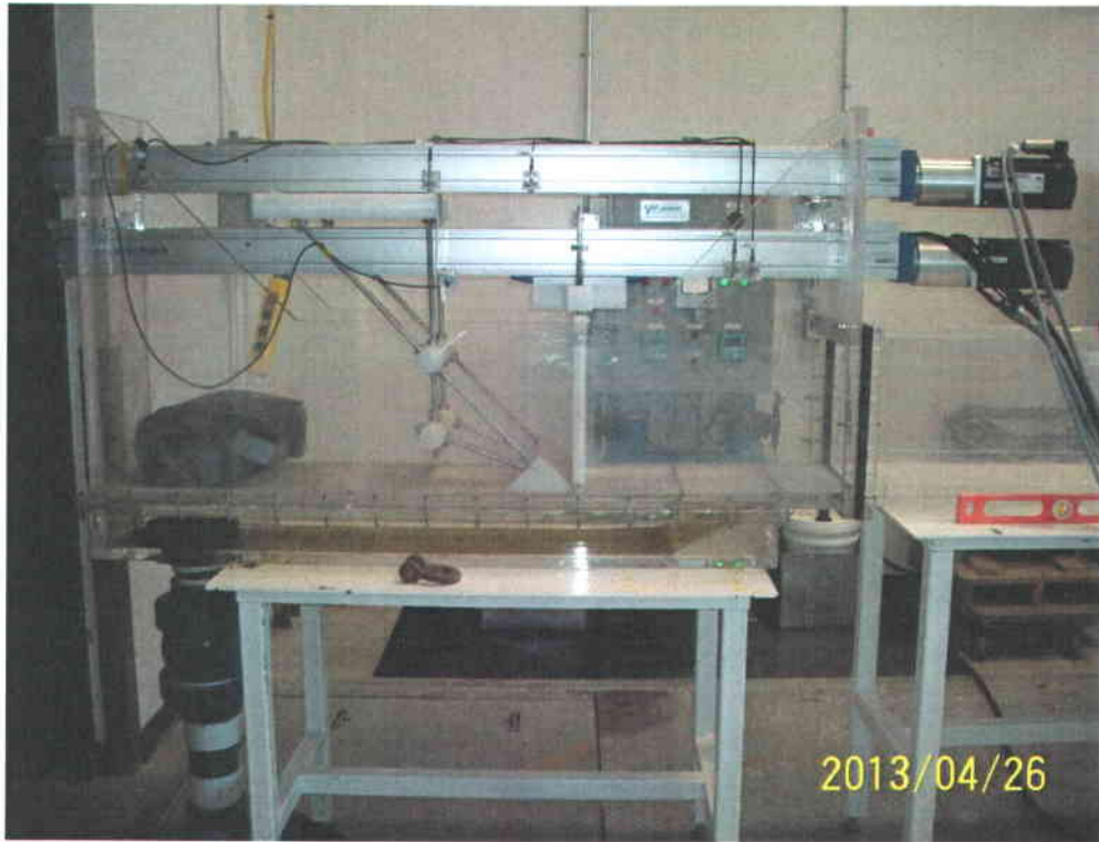
Figure 2.13 Batteur du canal à houle
