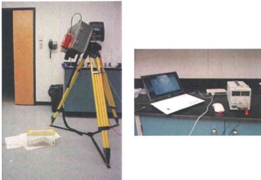
Figure 2.1 Le MAPLE montré sur un trépied (gauche) et système d'acquisition CR1000 (droite) (tiré de Aucoin, 2012)
