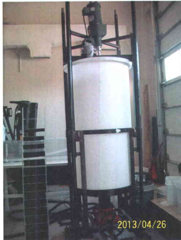
Figure 3.1 Réservoir utilisé lors de la calibration des appareils de mesure
