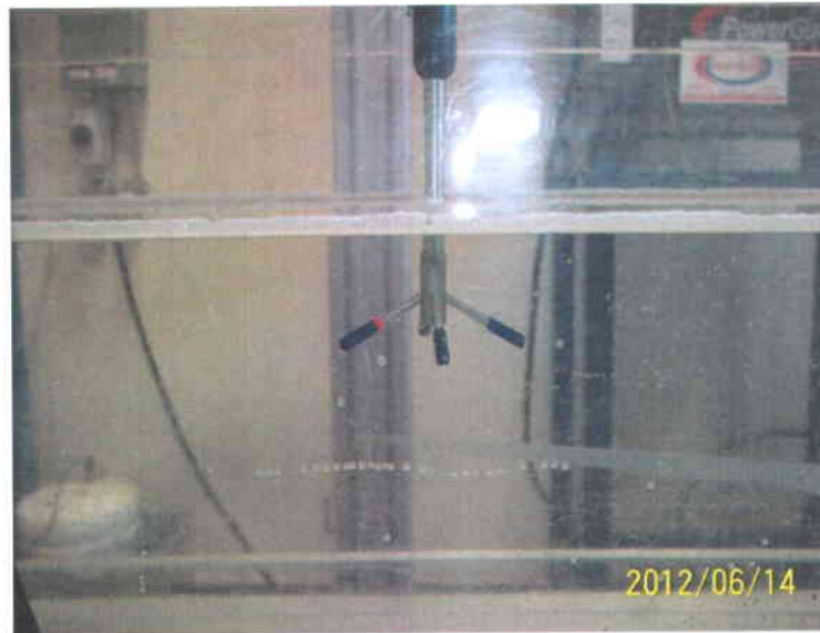
Figure 2.12 Tête du Vectrino II comprenant la sonde émettrice et les tiges réceptrices
