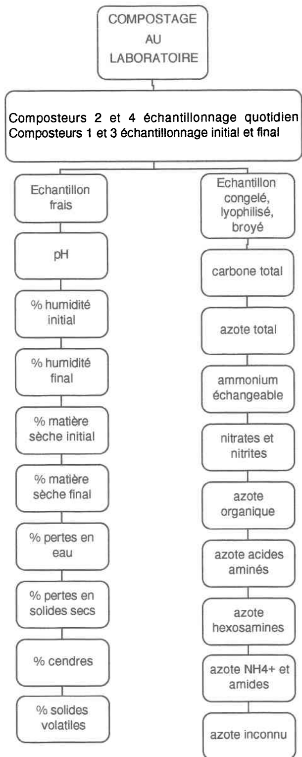
Fig. 3.3 : Compostage au laboratoire : séquence de dosages sur les échantillons prélevés dans le temps.
