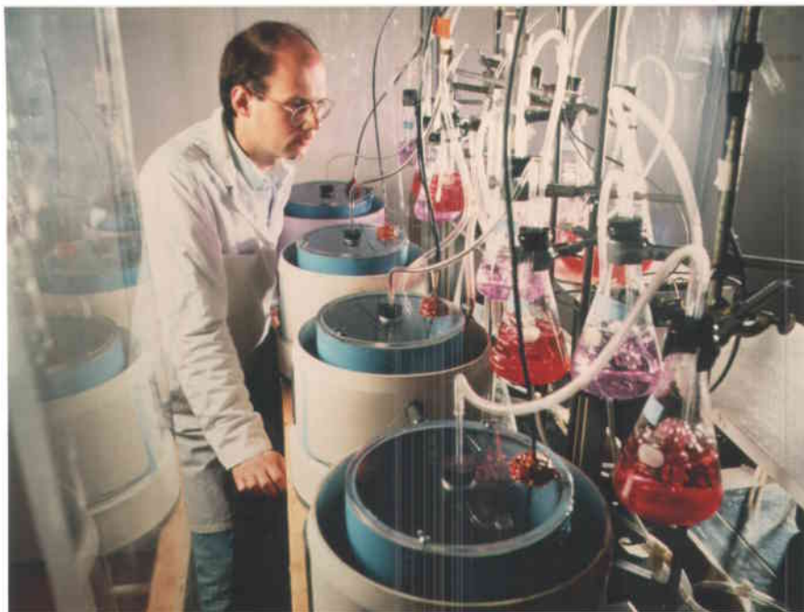
Fig. 3.1 : Montage des composteurs au laboratoire.
