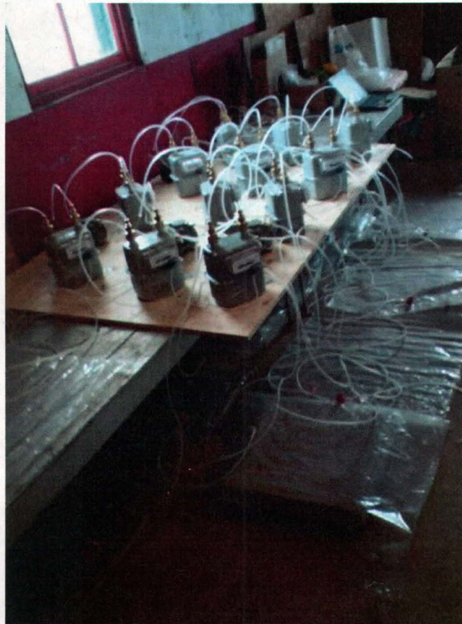
Figure 6 Illustration du dispositif d'échantillonnage des gaz
