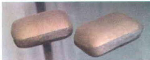
**Figure 1.1** Photo de briquettes de nickel pur
