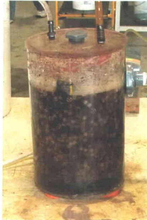
**Figure 3.3** Réacteur biologique utilisé lors des essais de traitement biologique du lixiviat
