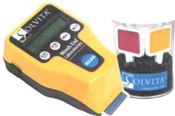
**Figure 1.14** Appareil DCR de *Solvita*
