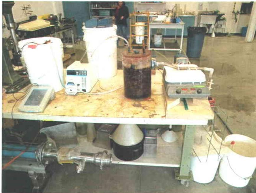
**Figure 3.7** Montage du traitement biologique en mode continu du lixiviat
