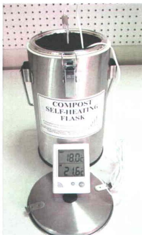
**Figure 1.15** Appareil utilisé pour le test auto-chauffage de Dewar
