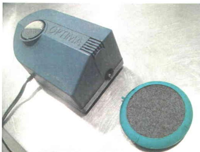
**Figure 3.4** Diffuseur en disque de 7,6 cm de diamètre et d'une pompe de marque *Hagen*, modèle *Elite Optima* utilisé dans le réacteur biologique au cours du projet
