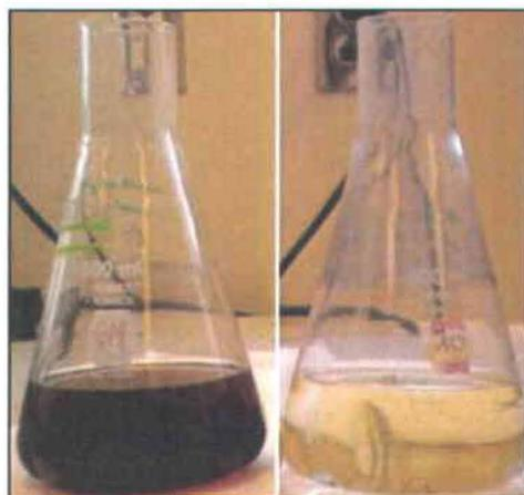
**Figure 8** Détermination de l'efficacité du charbon actif HR sur la coloration du lixiviat avant (à gauche) et après traitement (à droite) avec 5 g
