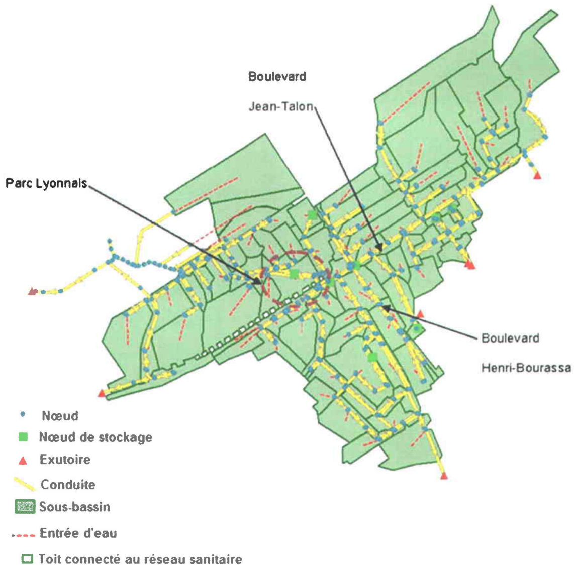
Figure 3.5 : Modélisation du réseau de drainage du collecteur de la Savane par la Ville de Québec (dans PCSWMM; BÉDARD et al. , 2010).
