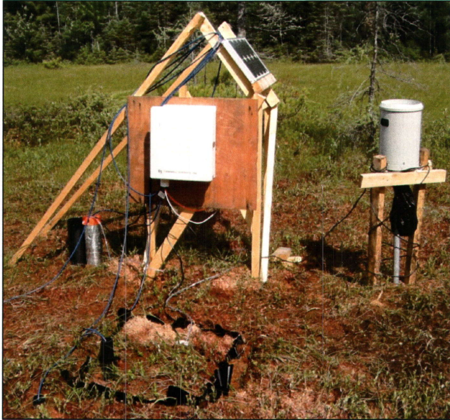
Figure 3-2. Lysimètre automatisé et pluviomètre installés sur la tourbière ombrotrophe de Pont-Rouge entre le 12 et 27 juillet 2010
