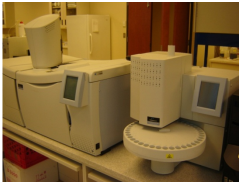
Figure 1-11 Appareil GC-MS utilisé pour l'analyse de l'atrazine et de ses métabolites
