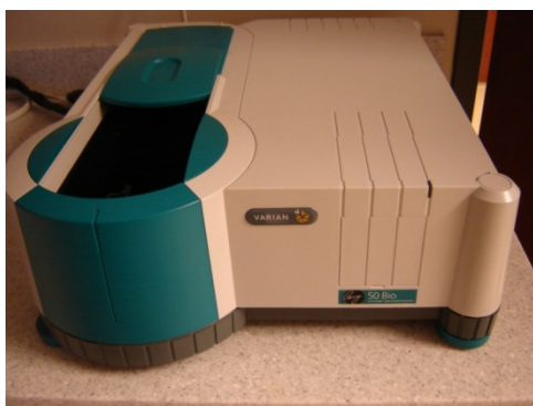
Figure 1-10 Spectromètre UV/visible modèle Carry UV 50 utilisé pour l'analyse des colorants
