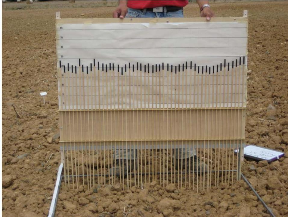
**Figure 3.2 Profilomètre utilisé pour caractériser le profil d'élévation du sol**
