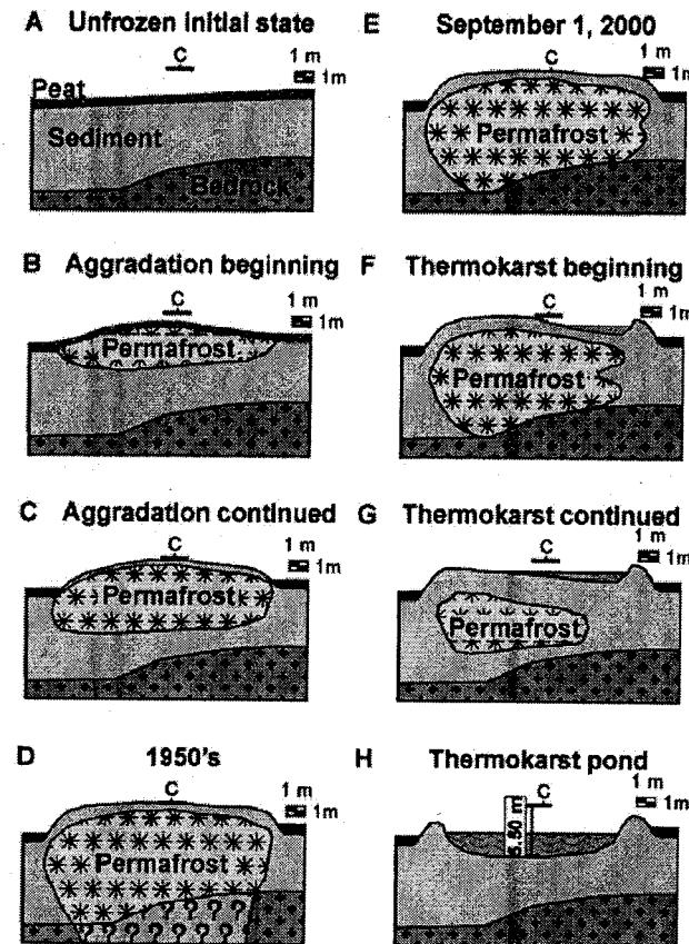
**Figure 1** Processus de formation et dégradation d'une palsu en zone de pergélisol discontinu, créant du coup une mare thermokarstique. Tiré de (Seppala 1986, Calmels et al. 2008).
