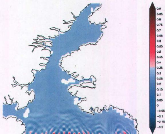
Figure 2.8 Réflexions parasites du mode externe à la frontière sud pour une mauvaise paramétrisation des conditions aux frontières, dans ce cas-ci, en l'absence d'une condition de radiation adéquate (MOM 4.0).
