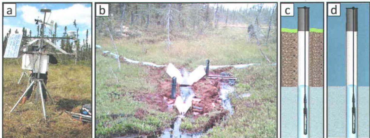
Figure 5 Mesures hydrométéorologiques de terrain : (a) Station météorologique ; (b) Canaux trapézoïdaux accompagnés de puits, à l'exutoire de la tourbière du site 1 ; (c) Schéma d'un puits enfoncé dans le sol tourbeux et équipé avec une jauge à pression hydrostatique (levellogger) ; (d) Schéma d'un puits enfoncé en fond de mare et équipé avec une jauge à pression hydrostatique.
