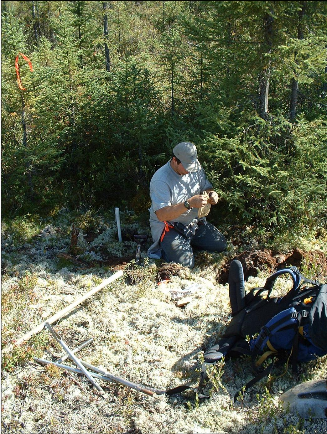
Échantillonnage de sol mettant à contribution l'installation du piézomètre P06. Le piézomètre nouvellement installé se trouve derrière l'échantillonneur. La tarière utilisée ainsi qu'une section de piézomètre se trouvent en avant plan.
