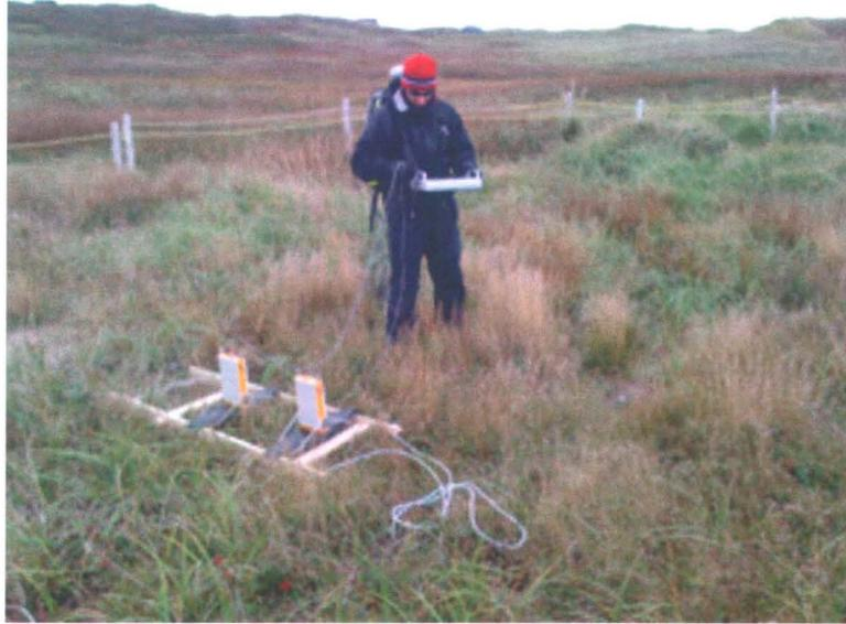
FIGURE 2.7 – Système radar ProEx avec antennes 200 MHz. L'unité principale d'acquisition est dans un sac sur le dos de l'opérateur. Un moniteur maintenu sur l'abdomen permet de contrôler les paramètres d'acquisition et de vérifier la qualité des données en temps réel.
