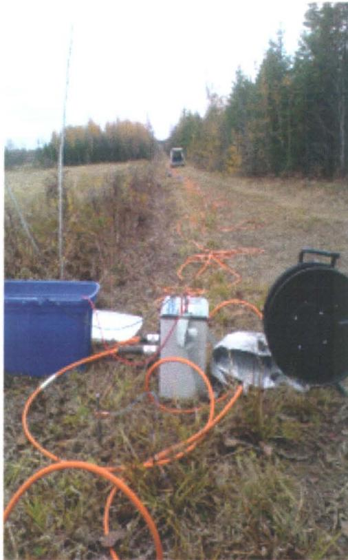
FIGURE 2.12 – Système SYSCAL Pro de l'INRS-ETE
