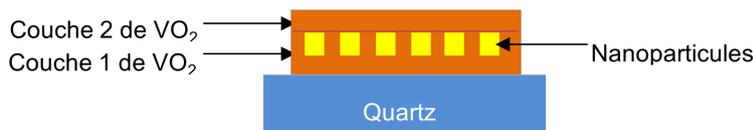
FIGURE 2.18 – Méthode 4 des procédés de fabrication.
