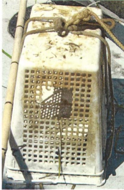
Figure 5.8 – Cage en plastique dans laquelle est installé le thermistor (photo prise le 10 juin 2004)
