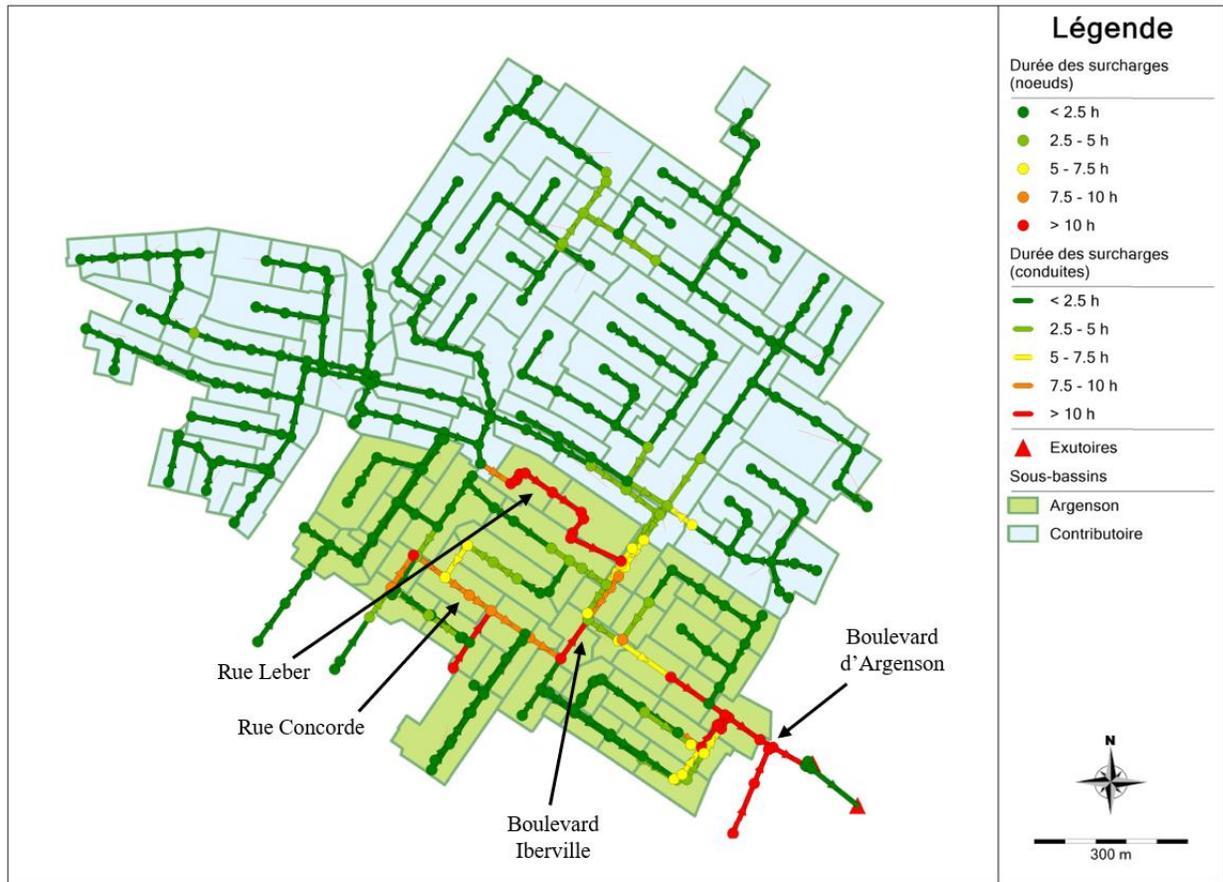
Figure 4.13 Durée des surcharges simulées aux nœuds et conduites du réseau lors de l'événement du 11 août 2012
