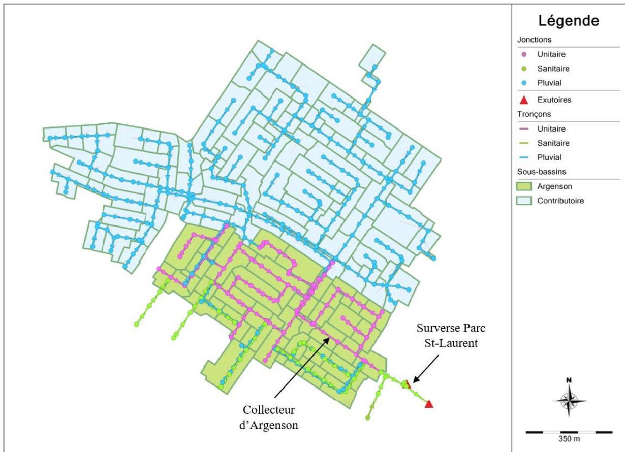
Figure 3.18 Schéma des réseaux unitaire et pluvial des bassins d'Argenson et contributoire
