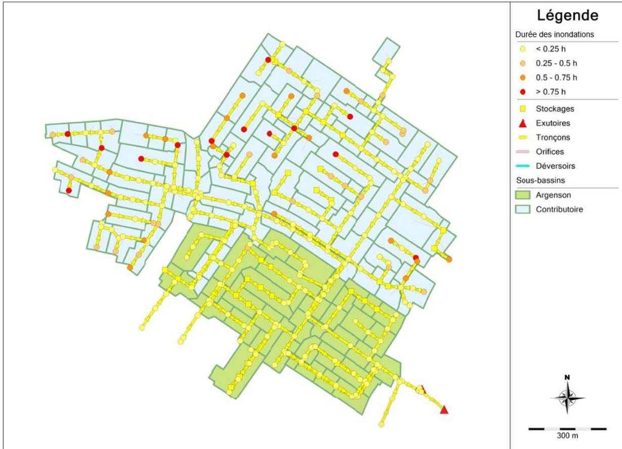
Figure 4.14 Durée des inondations de surface simulées aux nœuds du réseau lors de l'événement du 11 août 2012 après la mise en place de solutions de contrôle à la source sur l'ensemble du secteur à l'étude (scénario 8)
