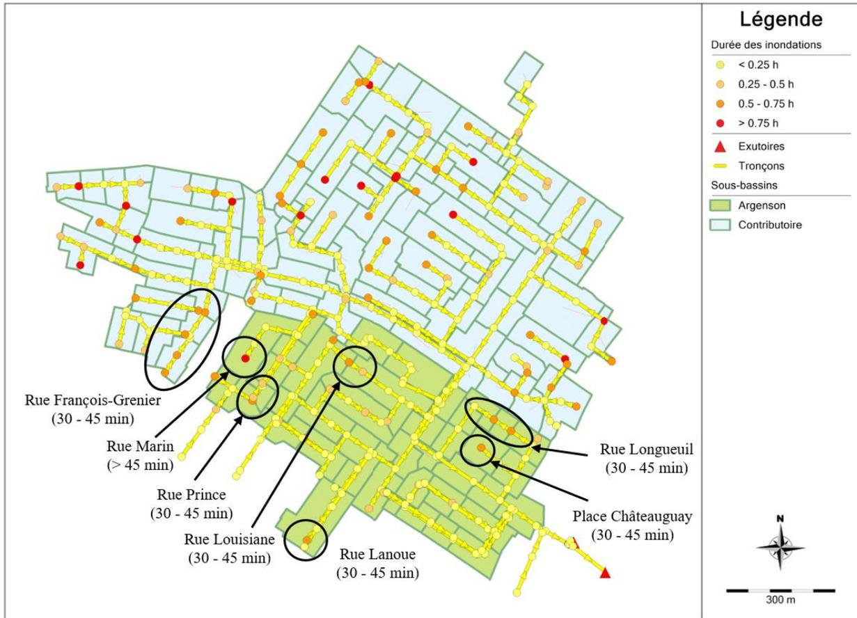
Figure 4.1 Durée des inondations de surface simulées aux nœuds du réseau lors de l'événement du 11 août 2012
