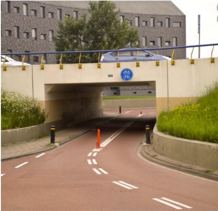
Figure 7. Exemple de croisement dénivelé comme mesure de perméabilité filtrée (ville de Houten aux Pays-Bas)
