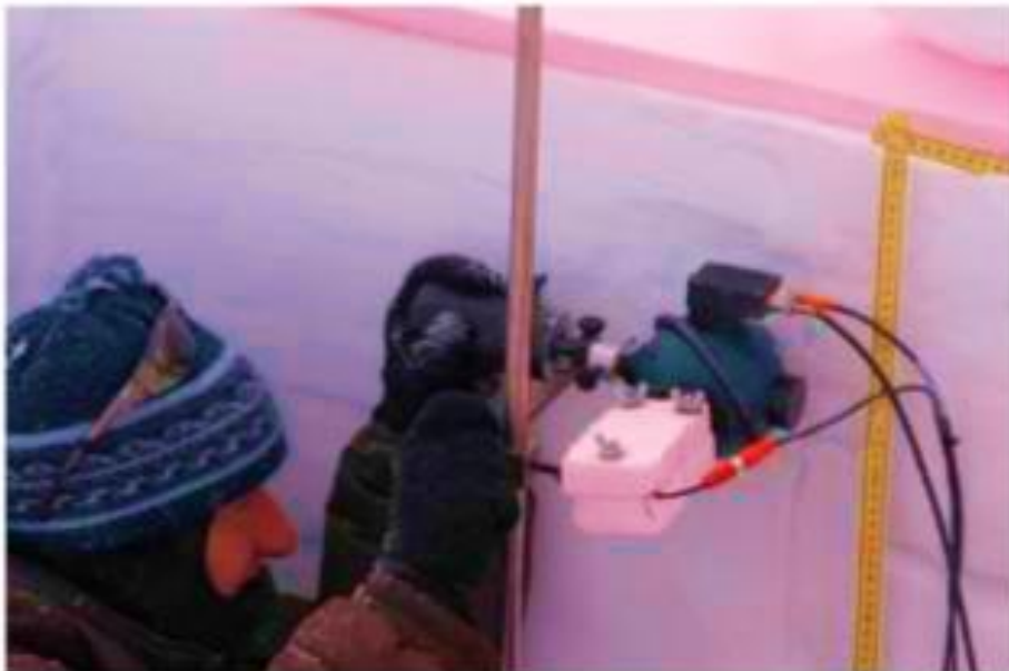
Figure 2-10 : Mesure de la SS en utilisant une sphère d'intégration (Montpetit et al. , 2011).
