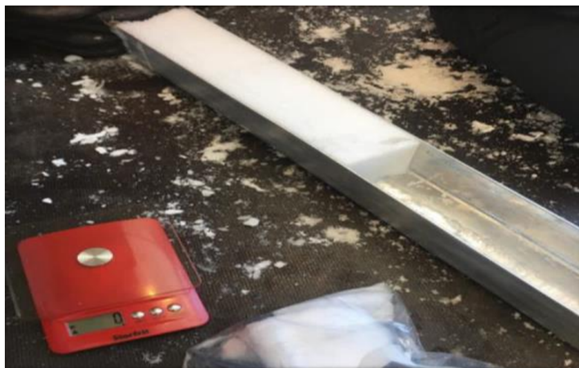
Figure 3-4 : La stratigraphie verticale à l'intérieur de la carotteuse, hiver 2018.
