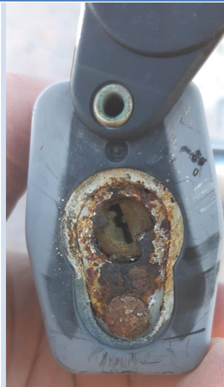
Présence de corrosion sur le cadenas mais toujours fonctionnel
