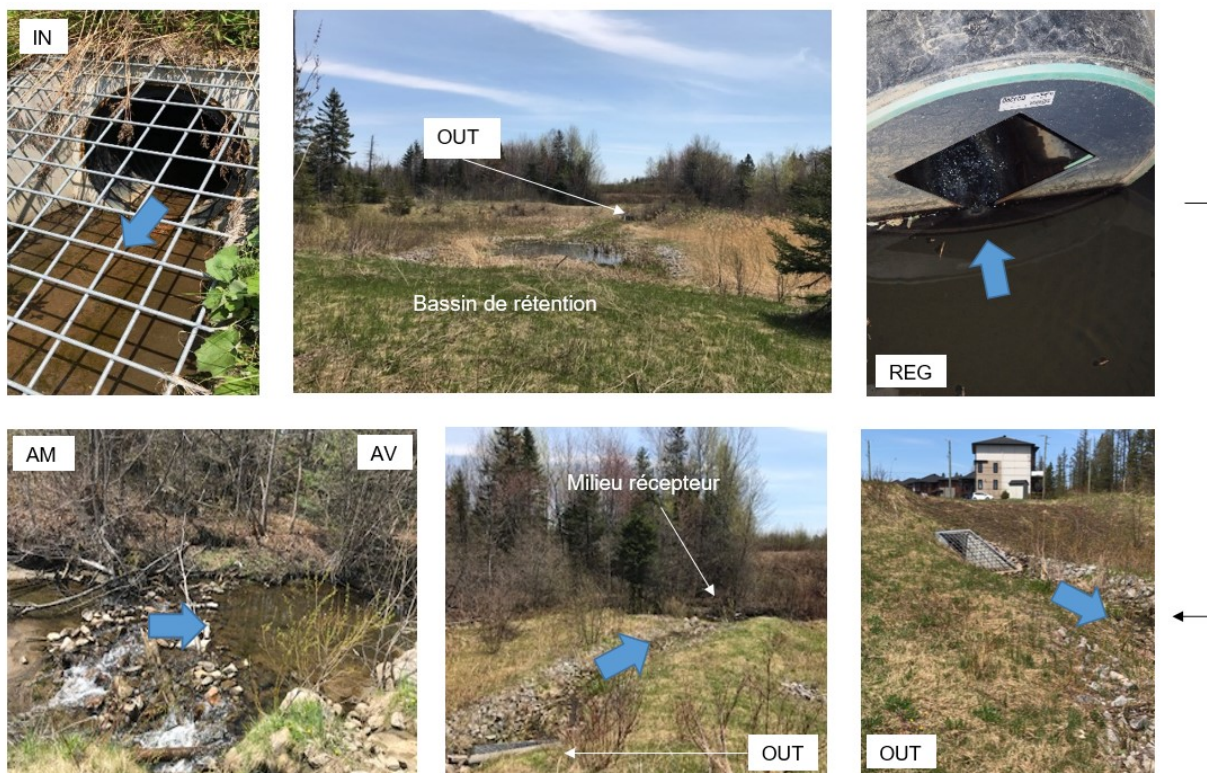
Figure 3.5 : Cheminement de l'eau de l'entrée du BS jusqu'au milieu récepteur au site VB
