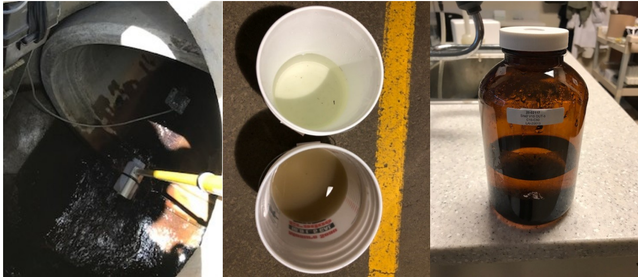
Figure 3.14 : Échantillonnage avec une perche au point IN1 au BSC (gauche), collecte des échantillons composites IN et OUT (centre) et exemple d'une bouteille pour les analyses d'hydrocarbures (droite)
