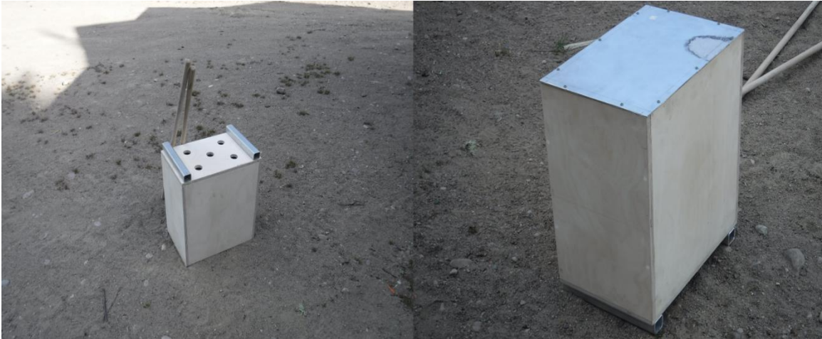
Figure 25: Matériel utilisé pour l'échantillonnage du bloc de tourbe utilisé dans la méthode du drainage
