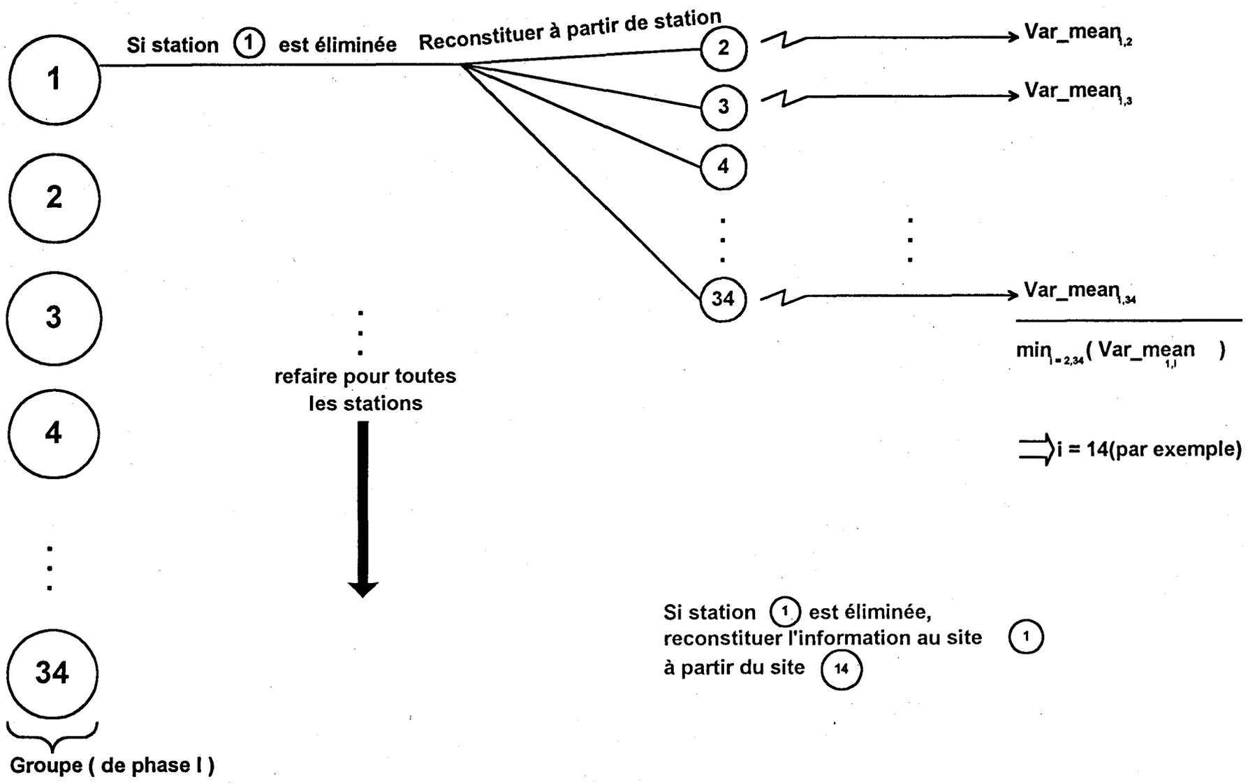
Figure 1a. Méthodologie de rationalisation pour k=1, identification des stations auxiliaires.
