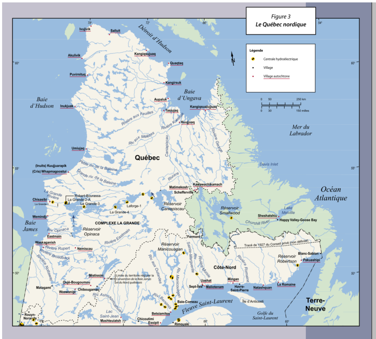
Figure 1.4 : Carte du Québec nordique avec la dérivation Laforge, d'après Hayeur (2001). Le sens d'écoulement d'une partie des eaux du réservoir Caniapiscou vers le complexe La Grande est indiquée par une flèche.
