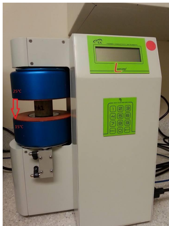
Figure 20: Compteur de flux de chaleur FOX50 ouvert avec un échantillon de sel.
