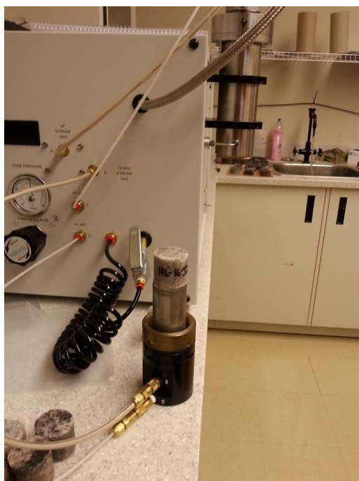
Figure 22: Échantillon d'halite sur la partie inférieure du réceptacle du porosimètre et perméamètre de Coretest systems.
