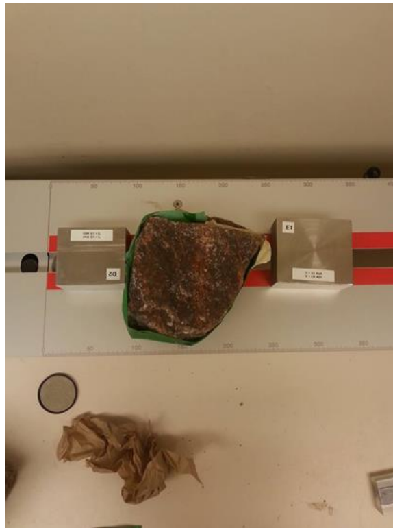
Figure 19: Échantillon d'halite impure avec sylvite et argiles sur le TCScan de LGM Lippmann.
