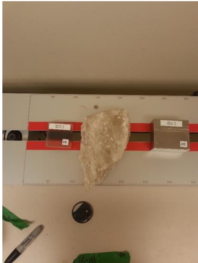
Figure 18: Échantillon d'halite blanche pure à 95% sur le TCSan de LGM Lippmann.
