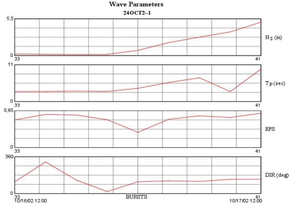
Paramètres des houles en fonction des séries de mesures (Bursts) : ( $H_s$ ) hauteur significative, ( $T_p$ ) période de pointe ou de pic, (EPS) énergie de la houle du pic principal, (DIR) direction de la houle de pic
