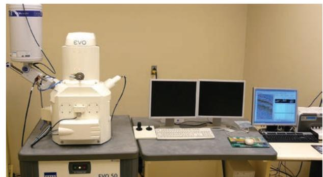
Microscope électronique à balayage (MEB)
