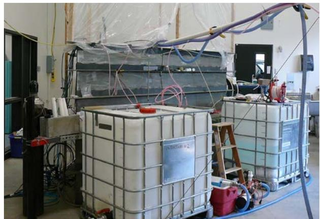
Essai d'extraction multiphase et de lavage de sol
