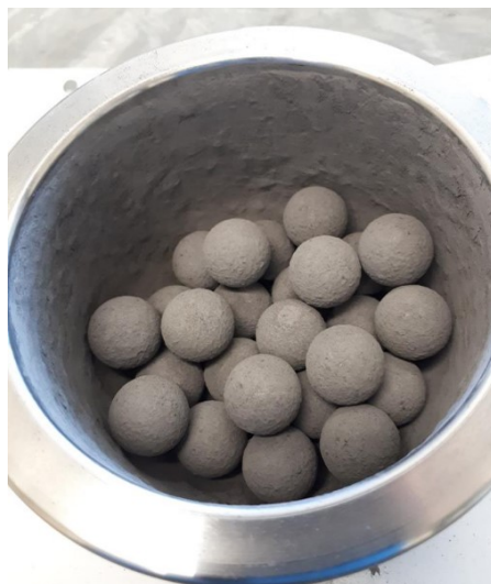
Figure 5.1 Photo montrant le phénomène de cimentation des scories lors du broyage
