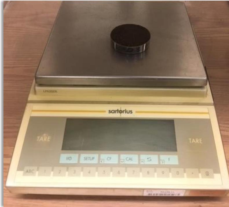
Figure 3.5 : Mesure du poids des échantillons du sol.
