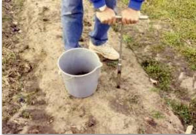
**Figure 3.2 : Prélèvement d'échantillons de sol par une tarière**
