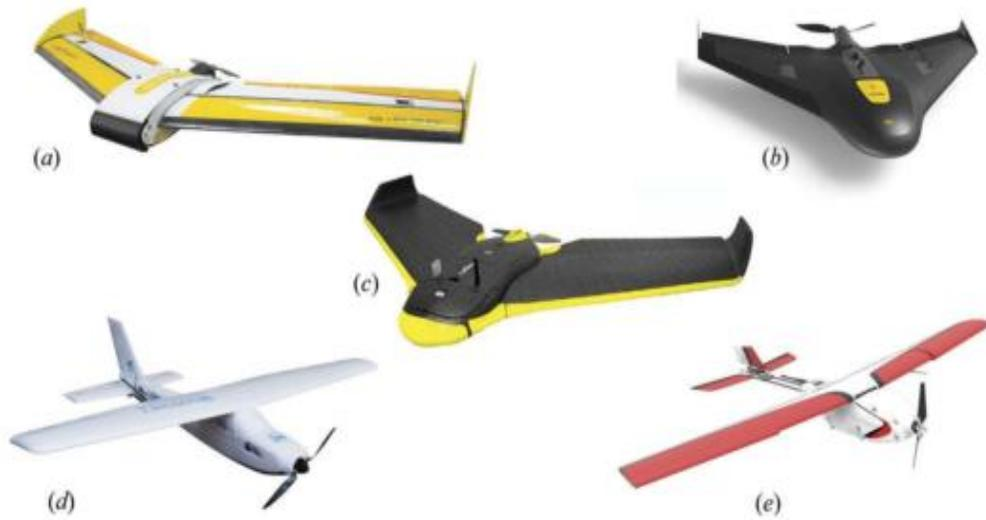
Figure 2.5 Exemples des drones à voilure fixe : (a) QuestUAV Q-200 Agri Pro; (b) Trimble UX5; (c) SenseFly eBee; (d) MAVinci SIRIUS Pro; et e) PrecisionHawk Lancaster (Pádua et al. 2017)
