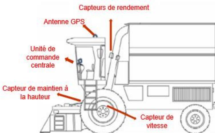
**Figure 2-2 : Composants d'un système de cartographie des rendements (Markinos et al. 2005)**
