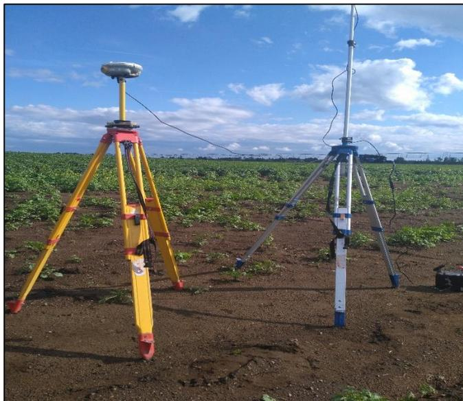
**Figure 3.8: Géoréférencement à l'aide d'un récepteur GPS RTK**
