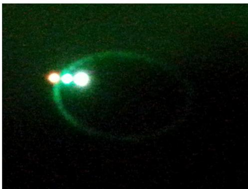
**Figure 4.1:** Halo de lumière interférant avec le faisceau SFG. De gauche à droite, les faisceaux signal, SFG et pompe.
